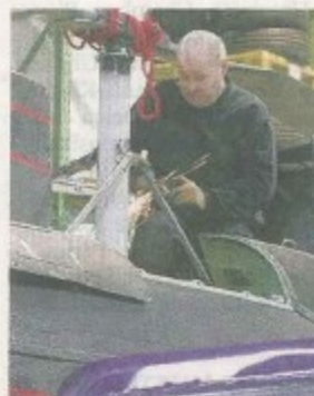
Günter Heiser schweiß selbst den Rotoraufbau fest.
